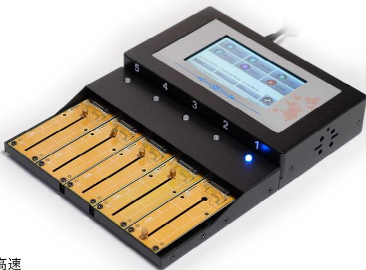
MX4 は最新の NVMe インタフェース M.2 デバイスデュプリケータで、毎分 9GB に迫る高速コピー、小型軽量で優れた携帯性、フルカラータッチスクリーンによる使い易さに加え SATA 及び USB3.0/2.0 ポートも搭載し、様々なデバイスのデュプリケーションニーズに対応します。
