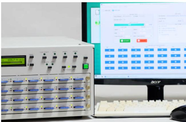
KVM接続によるGUIオペレーション。本機はPCを内蔵しておりKVMを接続するだけでGUIによる様々な操作を快適に行えます。
