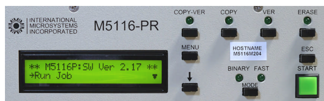
前面パネルのボタンを押すだけでジョブ設定可能
